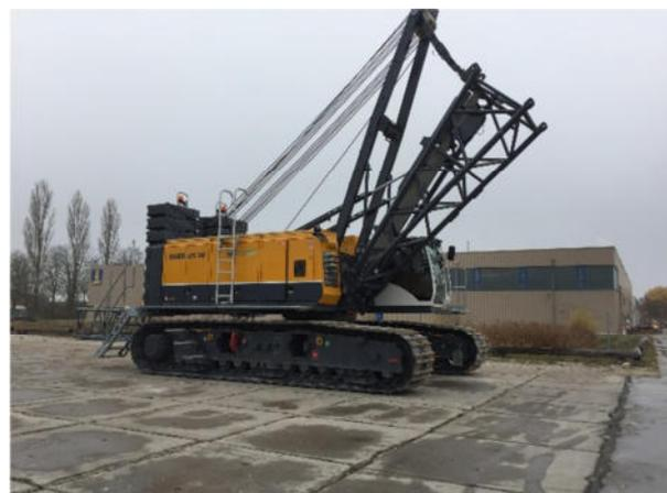
Abbildung 1-3: Bauer MC 96 Seilbagger für die Spätere Konfiguration als Schlitzwandgreifer
