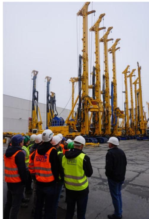
**Abbildung 1-1:** Lagerplatz der vormontierten Bohrgeräte für die kundenspezifische Ausrüstung und Endmontage
