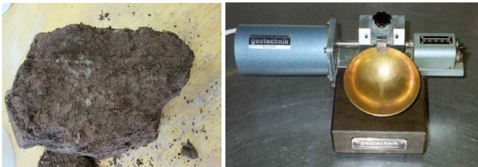
Bild 1: Links: Dunkelroter Mergel der Grabfeld-Formation. Rechts: Versuchsgerät nach CASAGRANDE zur Bestimmung der Fließgrenze
