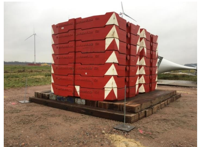
Abbildung 3: Versuchsfeld mit der maximalen Auflast von 280 t
