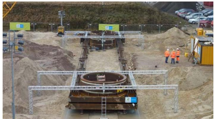
In Deutschland werden Stahlrohrpfähle im Wasser- und Offshore-Bau in der Regel durch Schlagrammung eingebracht. Mit dem alternativen Einsatz des Vibrationsverfahrens wären signifikante ökonomische und ökologische Vorteile verbunden, da der Schall an der Quelle reduziert und eine deutlich zügigere und ermüdungsärmere Herstellung ermöglicht wird.
