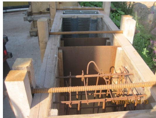
Abb. 1 + 2: Versuchsanordnung Hindernisbahn selbstverdichtender PP-Faserbeton
