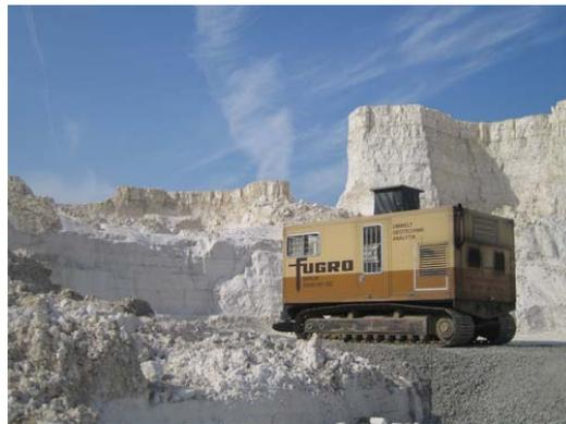
Die elektrische Drucksonde ist ein mobiles Gerät zur wirtschaftlichen und hochauflösenden Baugrund-erkundung. Beim Drucksondieren werden Sondierstangen, an deren unterem Ende die Messspitze montiert ist, mit konstanter Geschwindigkeit in den Boden gedrückt, wobei Spitzenwiderstand ( $q_c$ ), lokale Mantelreibung ( $f_s$ ) und gegebenenfalls Gesamtwiderstandskraft in Abhängigkeit von der Sondiertiefe gemessen werden können.
