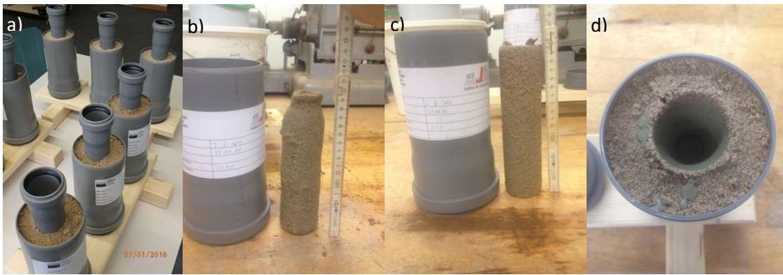
Abbildung 55a) Versuchsaufbau vor dem Verfüllvorgang, b) ausgeschalter Versuchskörper (umgebenden Boden vor Einbau Verfüllmaterial wassergesättigt, ca. 22 M-% Wassergehalt), c) ausgeschalter Versuchskörper (umgebenden Boden vor Einbau Verfüllmaterial ca. 3,0 M-% Wassergehalt), d) Blick in die verfüllte „Bohrung“ mit Trichterbildung
