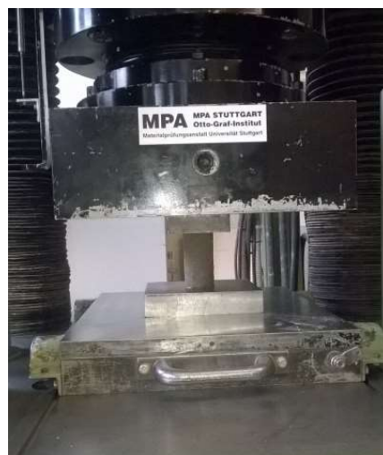
Abbildung 56: Prüfung der einaxialen Druckfestigkeit
