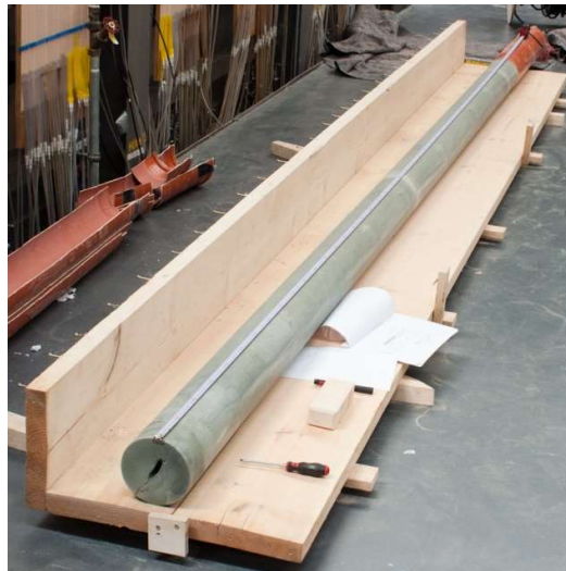
Abbildung 42: Verpresste und instrumentierte EWS vor Einbau in den Großbehälter
