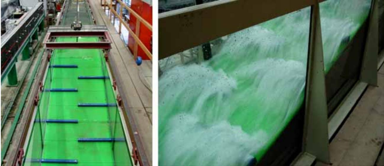
Abb. 5: Rippenanordnung bei Versuchsdurchführung
