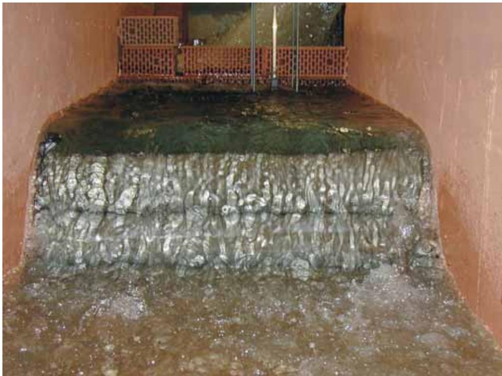
Abb. 4: Überströmungsversuch an einem Verbundsystem aus drei Geogewebeschläuchen (Höhe ca. 35 cm) bei einer spezifischen Belastung von  $q_{\text{Modell}} = 140 \text{ l/(sm)}$  (entspricht  $q_{\text{Natur}} = 550 \text{ l/(sm)}$ )
