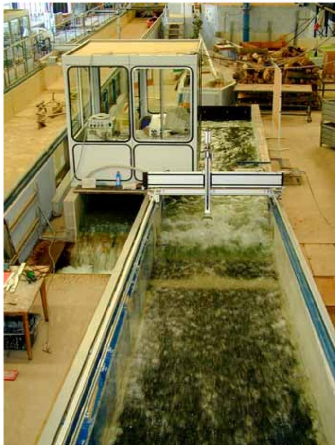
Abb. 7: Energieumwandlung am Böschungsfuß – Blick von oberstrom (vgl. BIEBERSTEIN ET AL. 2002)
