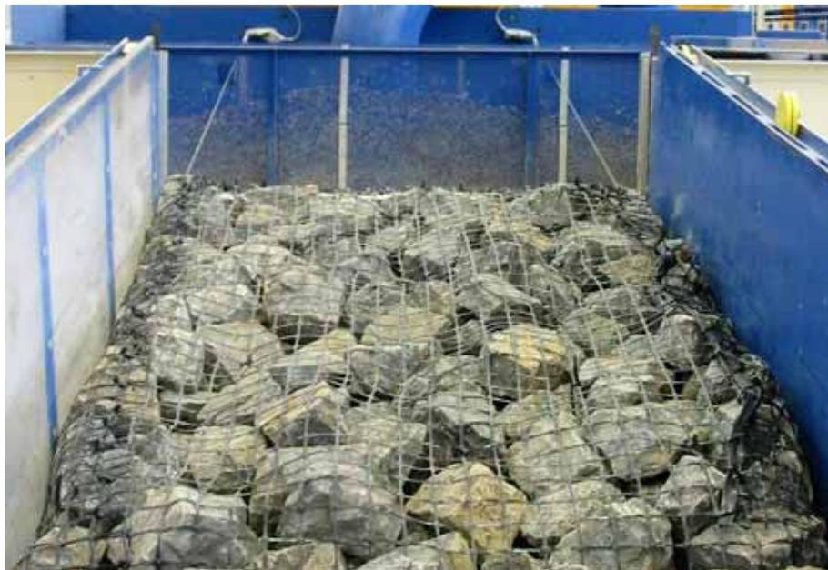
Abb. 7: Geogittermatratze bei den Experimenten an der Universität Stuttgart
