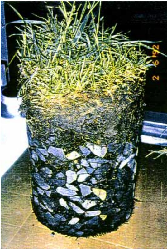
Abb. 1: Bohrkern aus einem Deckwerk aus Mastix-Schotter mit aufgebracht Humusschicht und Begrünung (Quelle: ELSKENS 1995)
