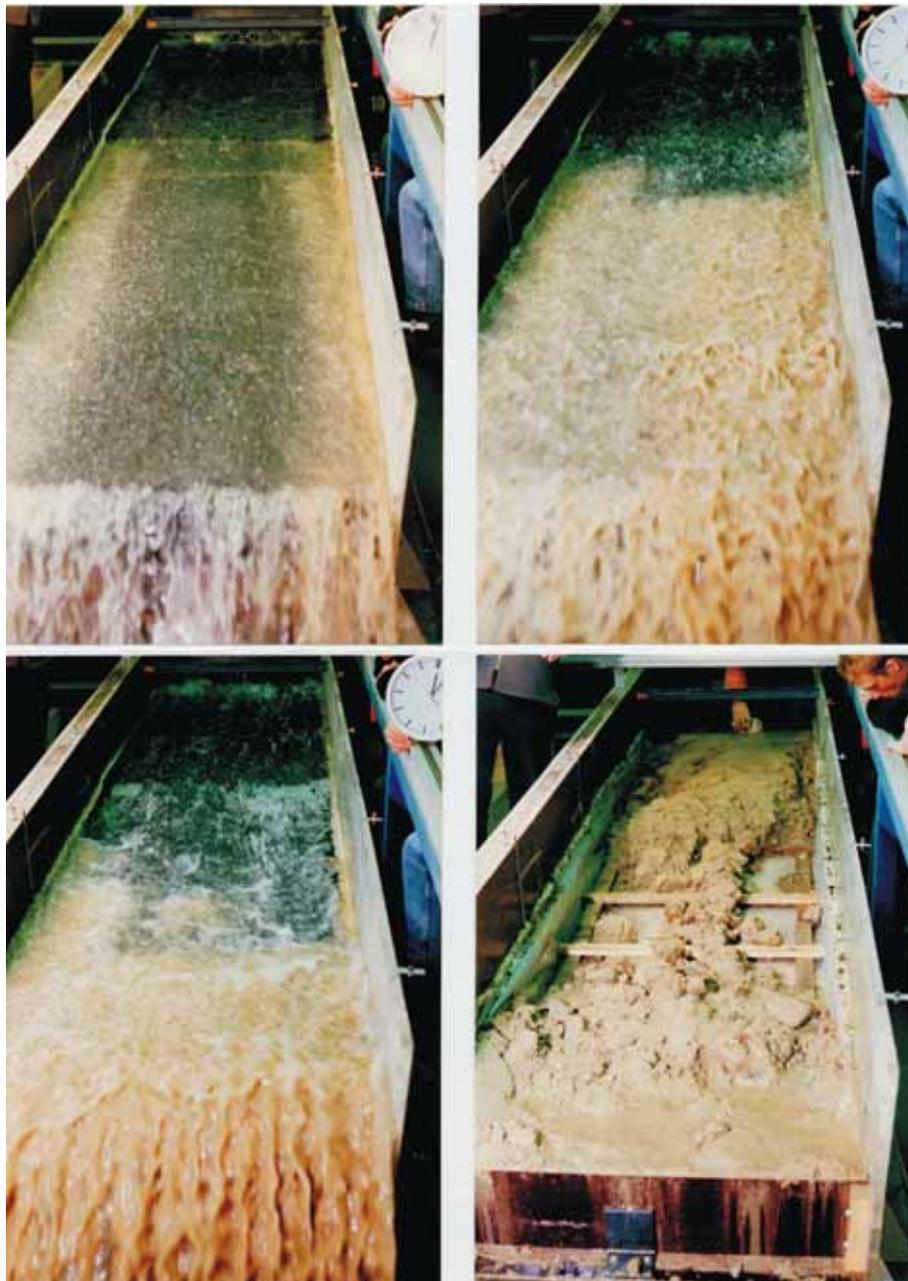
Abb. 11: Ausspülungen auf einer nur mit „Erosionsschutz-Matten“ befestigten Böschung (Foto: TRL)
