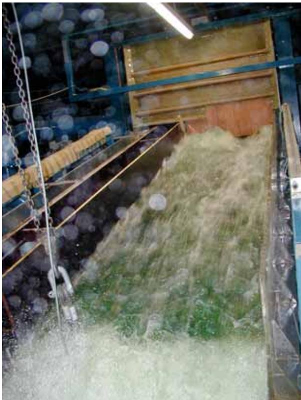
Abb. 5: Kiprinne – Selbsttragendes Deckwerk aus Mastix-Schotter bei einer Belastung von  $q = 360 \text{ l}/(\text{sm})$  bei einer Böschungsneigung von 1:5)
