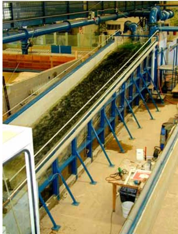
Abb. 6: Halbdamm-Modell zur Durchführung von Überströmungsversuchen mit einer Böschungsneigung von 1:6 während des Betriebes
