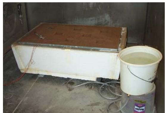
Abb. 57: Modifizierter Versuchskasten für die Frost-Tau-Wechsel in der Klimakammer
