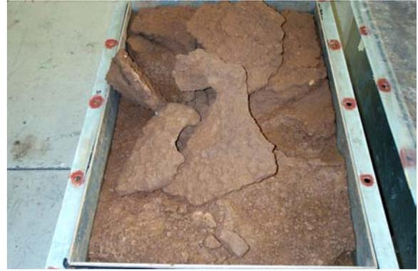
*Abb. 54: Unbehandelter Lösslehm mit Schrumpfrissen vor und nach dem Überströmen*
