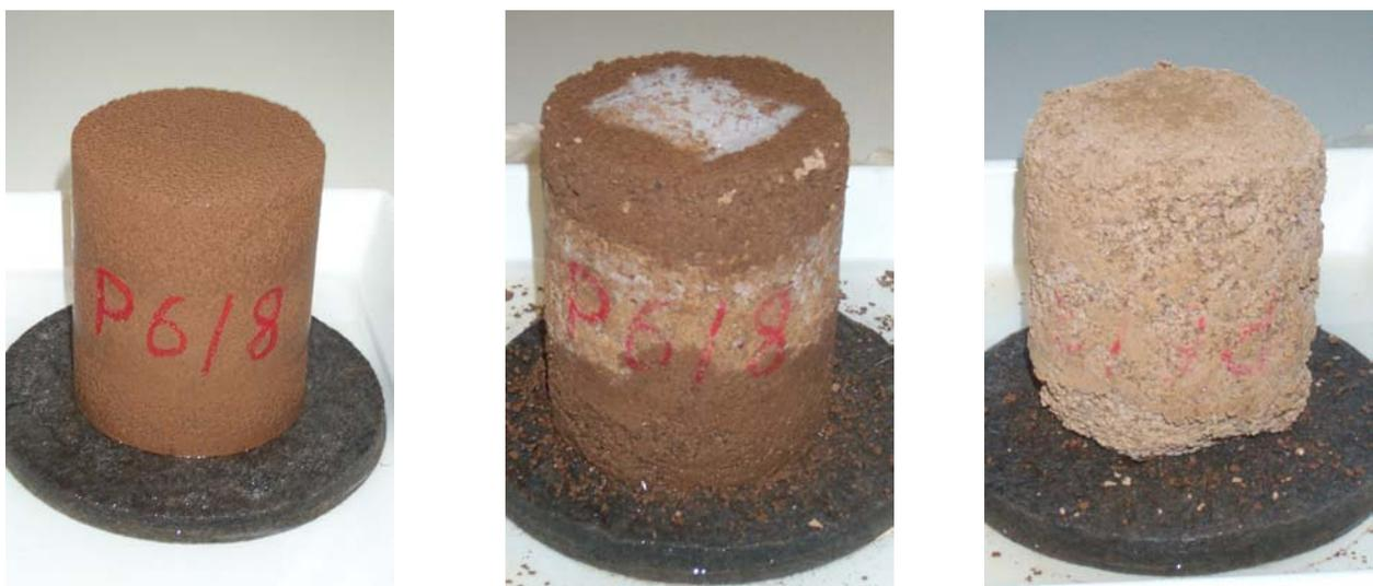
Abb. 59: 7 Tage alte, kalkstabilisierte Probe vor sowie nach 3 und 6 Frost-Tauwechselln
