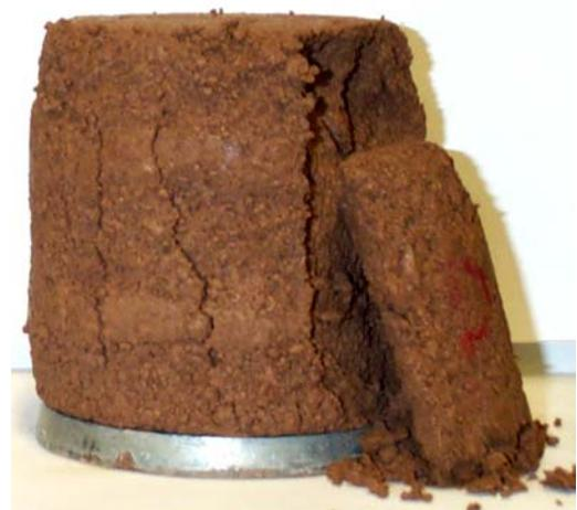
Abb.60: Ergebnisse einaxialer Druckversuche an unbehandeltem Lösslehm, mit Weißfeinkalk (2%, 4%, 6%) stabilisiertem Lösslehm (7 Tagen Abbindezeit) und nach anschließenden 6 Frost-Tauwechseln
