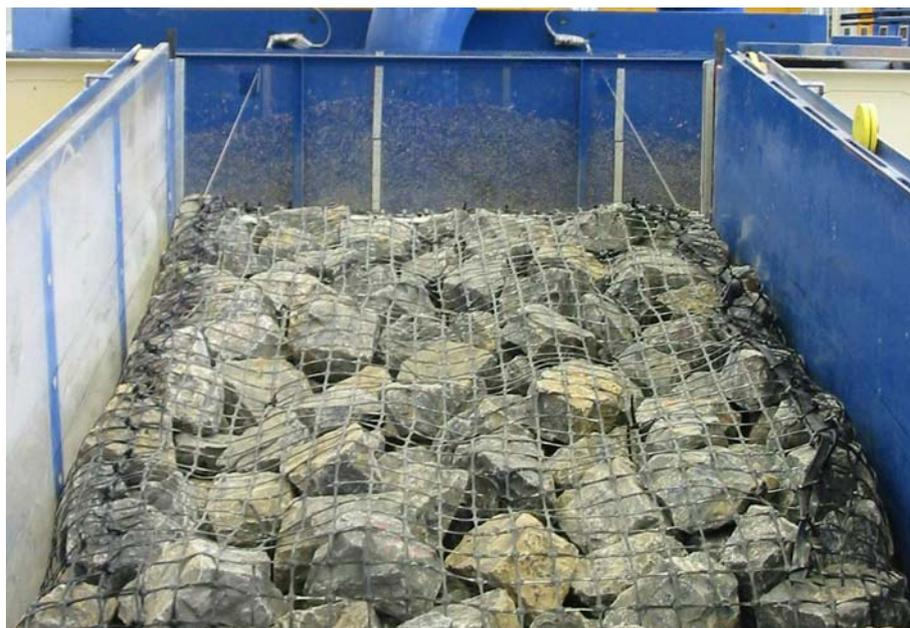
Abb. 34: Geogitterummantelte Steinmatratze mit den zwei Zugseilen
