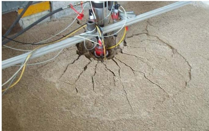
Bild 3.2.8 Bei Laborversuchen aufgetretener Grundbruch bei sehr dicht eingebautem Sand
