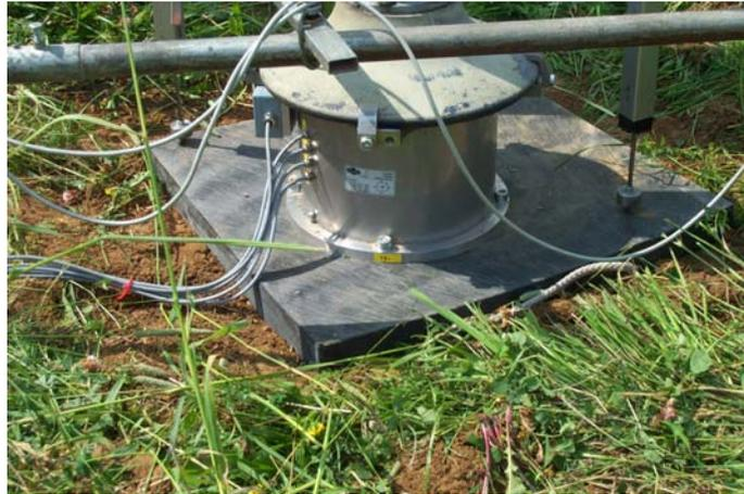
Bild 3.2.17 „Flügelbildung“ an der Ecke einer Abstützplatte aus Kunststoff mit abgestützter Baumaschine und Stützlastsensor
