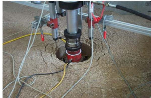
Bild 3.2.9 Grundbruchtyp C bei den Messungen auf Lösslehm und auf sehr locker eingebautem Sand
