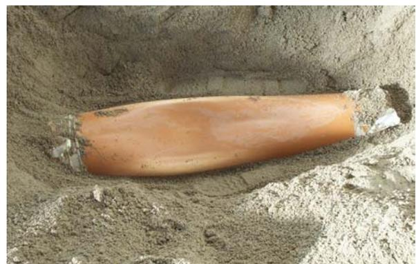
Bild 3.2.11 Bruchfigur und verformtes Rohr nach Belastung des sehr dicht gelagerten Sands mit Hohlraum unter der Lasteinleitungsfläche
