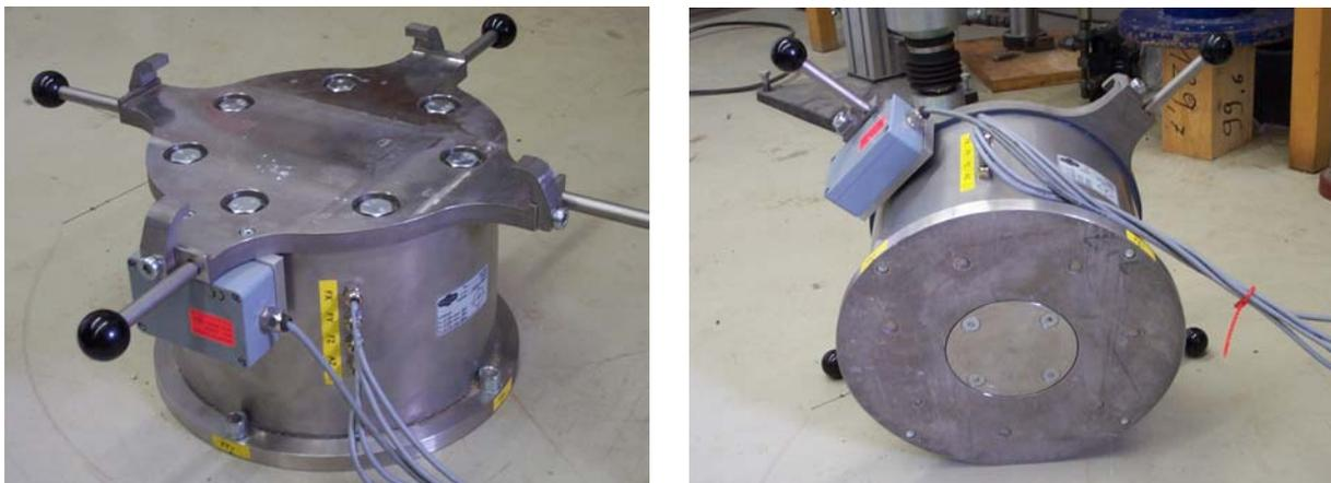
Bild 3.1.1 Lastsensoren zur Messung von Vertikal- und Horizontallasten
