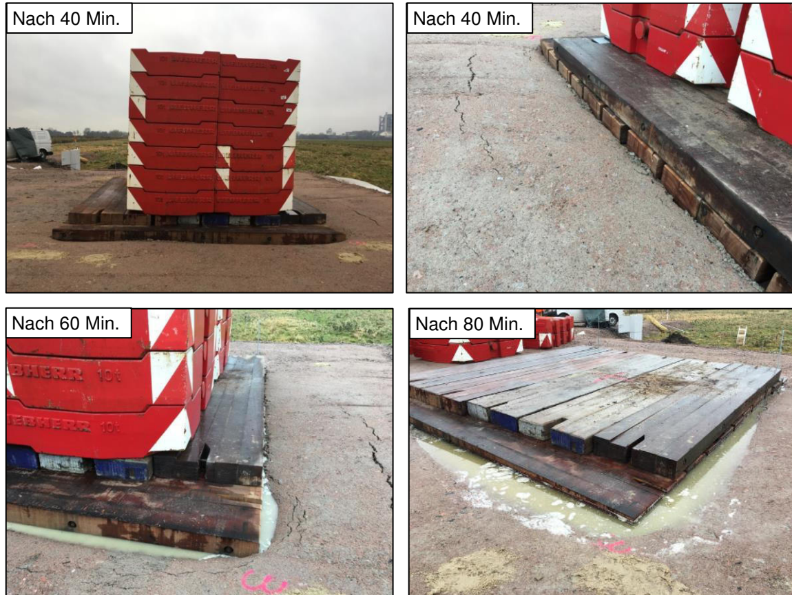
Abbildung 4.12: Zeitliche Entwicklung der Setzungen der Kranmatte während der Konsolidationsphase mit deutlichem Austreten von Porenwasser
