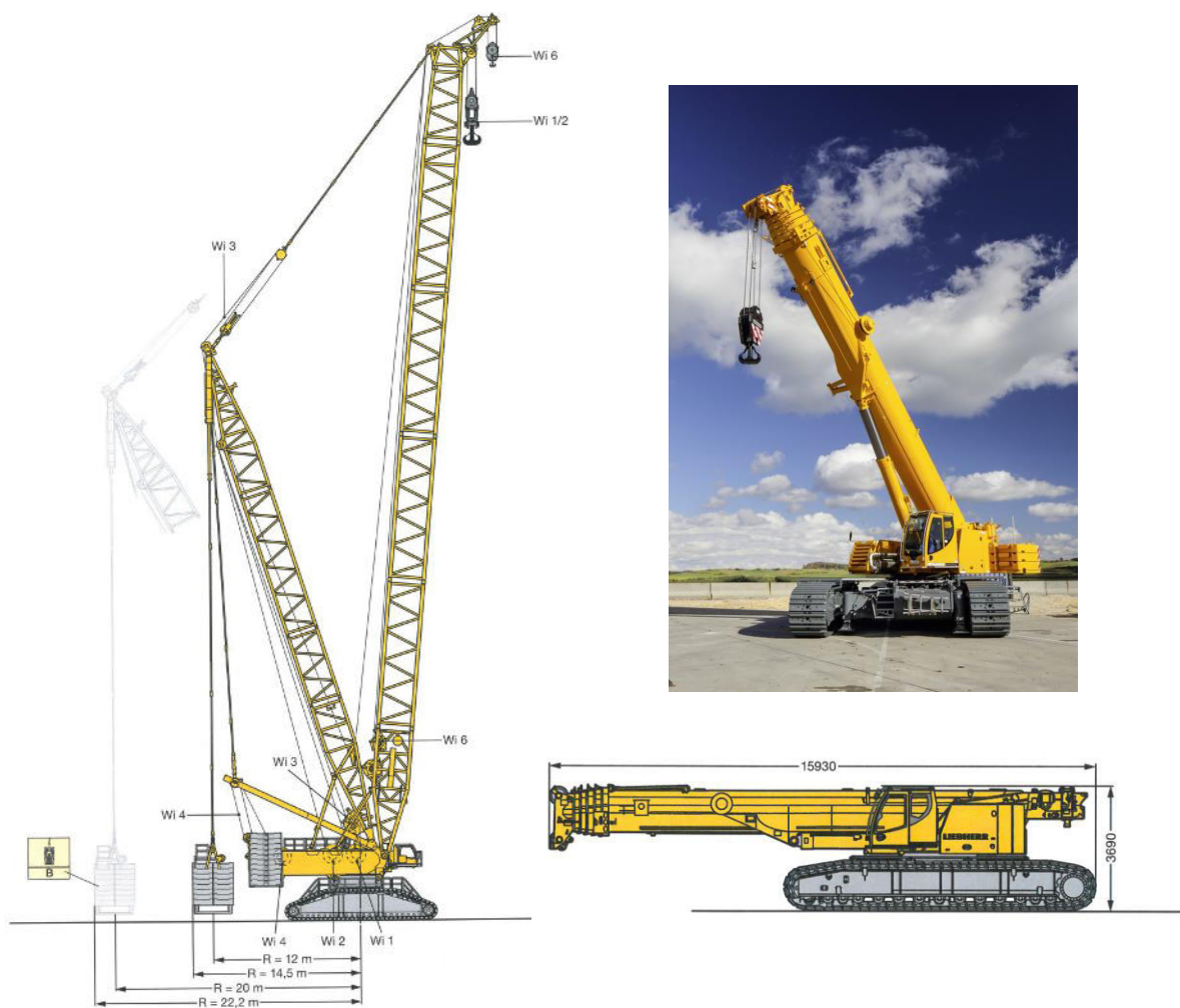
Abbildung 5.5: Verwendete Mobilkräne: Gittermastkran Liebherr LR 11000 (links) und Teleskopraupenkran Liebherr LTR 1220 (rechts) [Liebherr]
