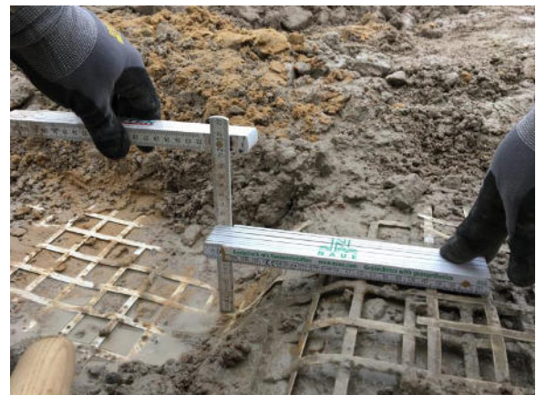
Abbildung 4.11: Vertikale Verformungen der Tragschicht an der Geländeoberkante nach Entlastung und Entfernen der Kranmatte (links) und Versatz von ca. 10 cm des Geogitters in der oberen Lage im Randbereich der Kranmatte (rechts)
