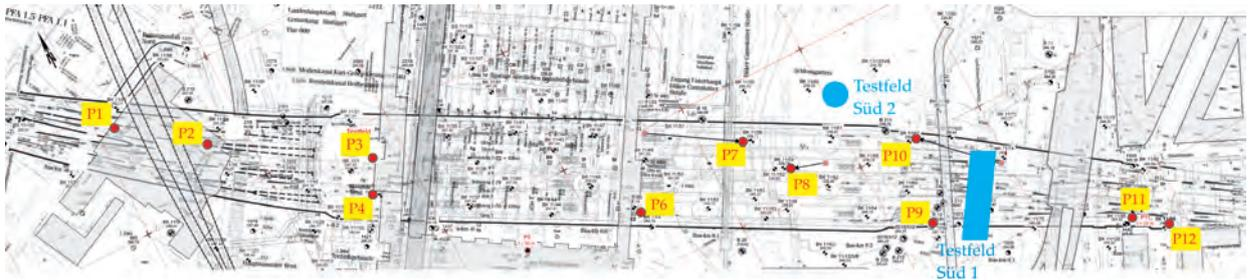
Abbildung 7.28: Lageplan der Pressiometerbohrungen im Planfeststellungsabschnitt 1.1, Talquerung mit Hauptbahnhof, Stuttgart 21
