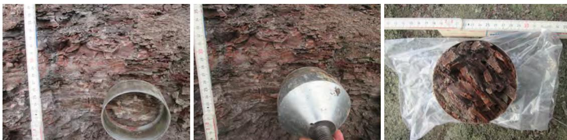
Abbildung 7.7: Probennahme mit zugesägten Ausstechzylindern
