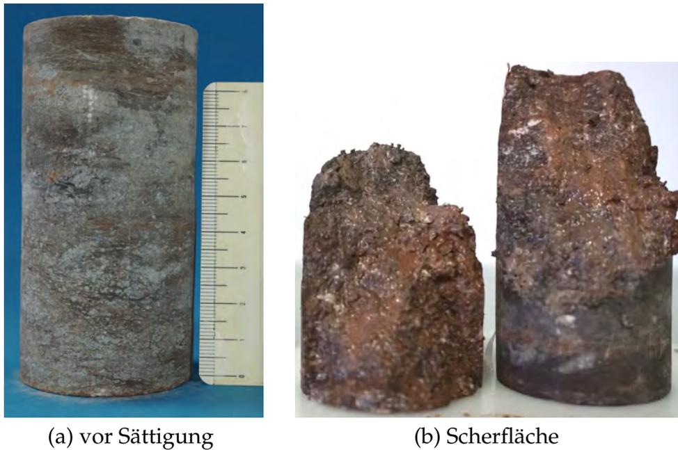
Abbildung 7.12: Grabfeld-Formation, V0/V1, unausgelaugt. Gestein wurde mit einem back pressure von 800 kPa versucht zu sättigen. Erreichter B-Wert 0,78. Nach Versuchsende zeigte sich, dass insbesondere die Tonpartien Wasser aufgenommen hatten und die Scherfläche dadurch stark plastifiziert war.
