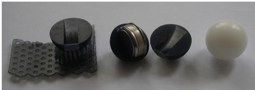
Abbildung B.9: Temperatursensoren zur Messung der Temperatur innerhalb der Kugelpackung, links: Kugelhalbschale mit Vertiefung für den Sensor nach der Herstellung, mitte: Kugelhalbschalen mit eingelegtem Sensor, rechts: Kugel aus Kugelpackung zum Vergleich
