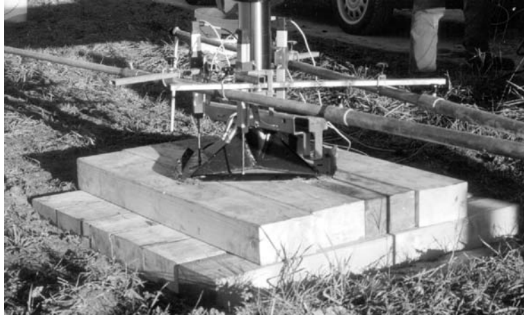
Bild 6.1 Messaufbau und quadratischer Unterbau aus Kanthölzern mit einer Kantenlänge von 120 cm
