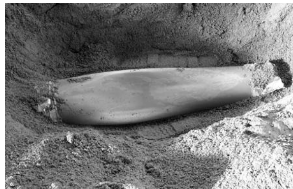
Bild 5.8 Bruchfigur (links) und verformtes Rohr (rechts) nach Belastung des sehr dicht gelagerten Sands mit Hohlraum unter der Lasteinleitungsfläche
