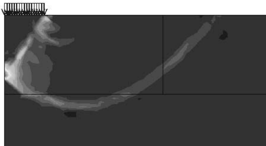
Bild 7.7 Inkrementelle Scherdehnungen zur Visualisierung der Scherfuge bei eintretendem Bruch
