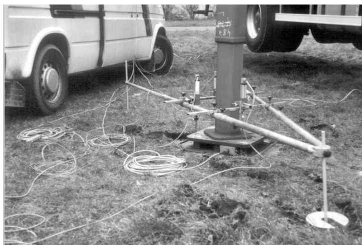
Bild 6.2 Messaufbau und Kraftmessung durch externe Lastplatte mit einer Kantenlänge von 50 cm
