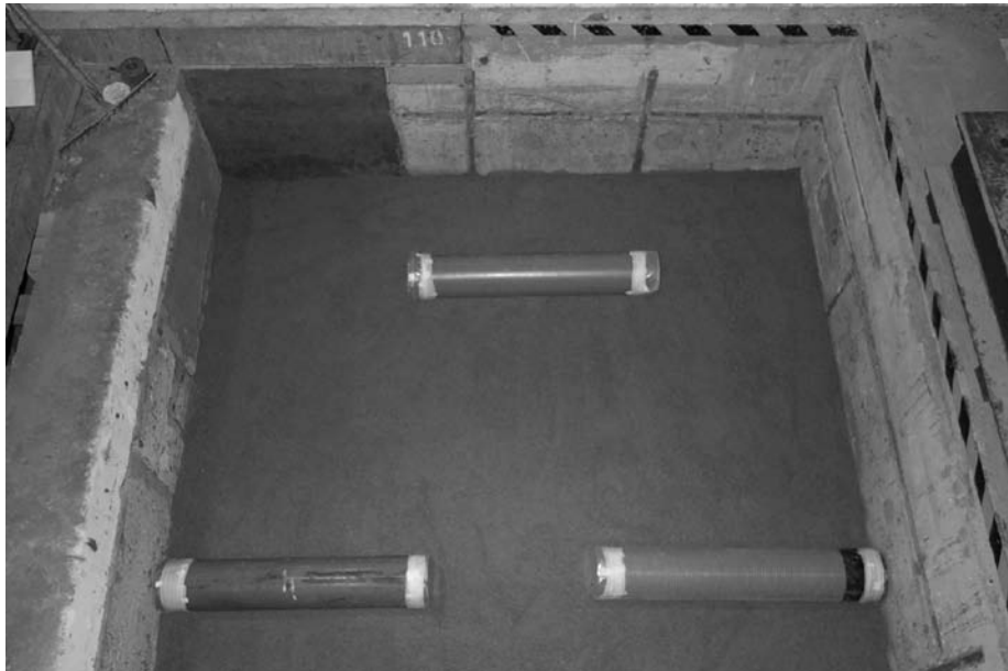
Bild 4.5 PVC-Rohrleitungsstücke zur Simulation von Hohlräumen im Untergrund; Einbau in die Versuchsgrube bei sehr dicht gelagertem Sand
