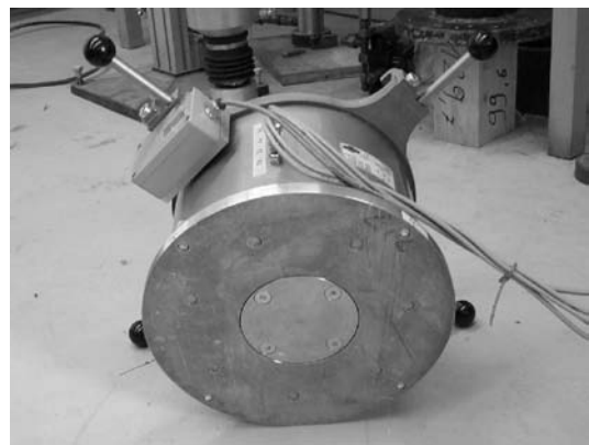
Bild 10.1 Prototyp des entwickelten Messensors für die Tragfähigkeitsprognose links: seitliche Ansicht rechts: Ansicht von unten
