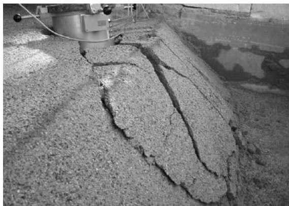
Bild 5.10 Bruchschollen von Böschungen unterschiedlicher Höhe im Sand; Austritt der Gleitfuge am Böschungsfuß (Links) bzw. in der Böschung selbst (rechts)
