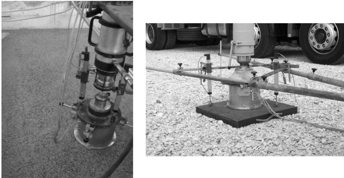
Bild 10.2 Einsatz des Messensors bei Laborversuchen auf dicht gelagertem Sand (links) und bei Feldmessungen auf einer Schottertragschicht (rechts)
