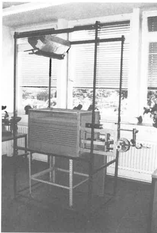
Bild 4.1: Versuchsaufbau für die kleinmaßstäblichen Modellversuche mit Belastungs- und Rieseleinrichtung
