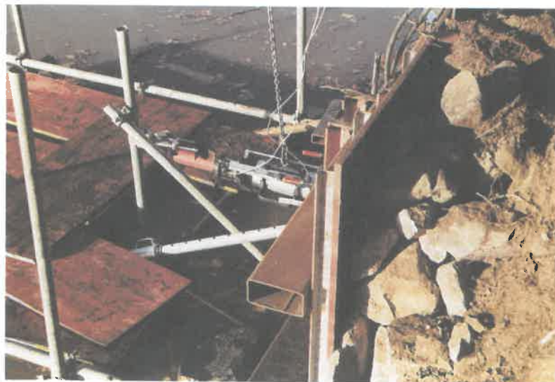
A8.4: Widerlager und Belastungseinrichtung
