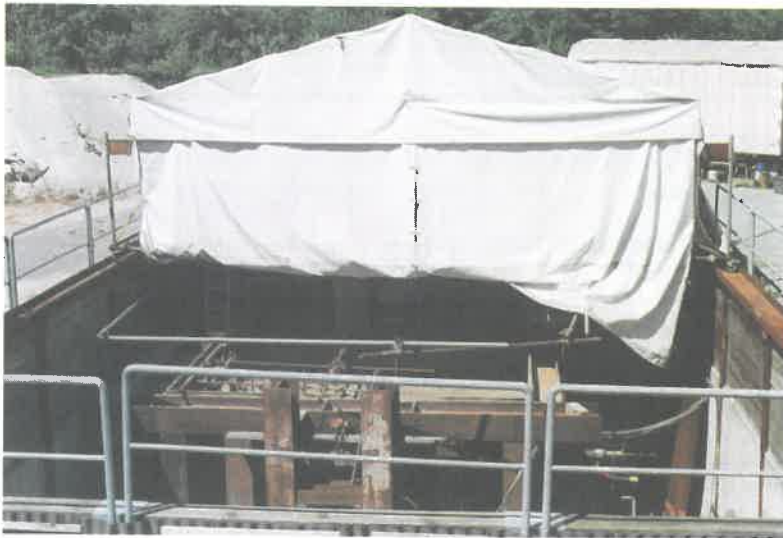
Bild 5.1.1: Versuchsgrube mit Stahlbehälter und Zeltüberdachung (Foto)
