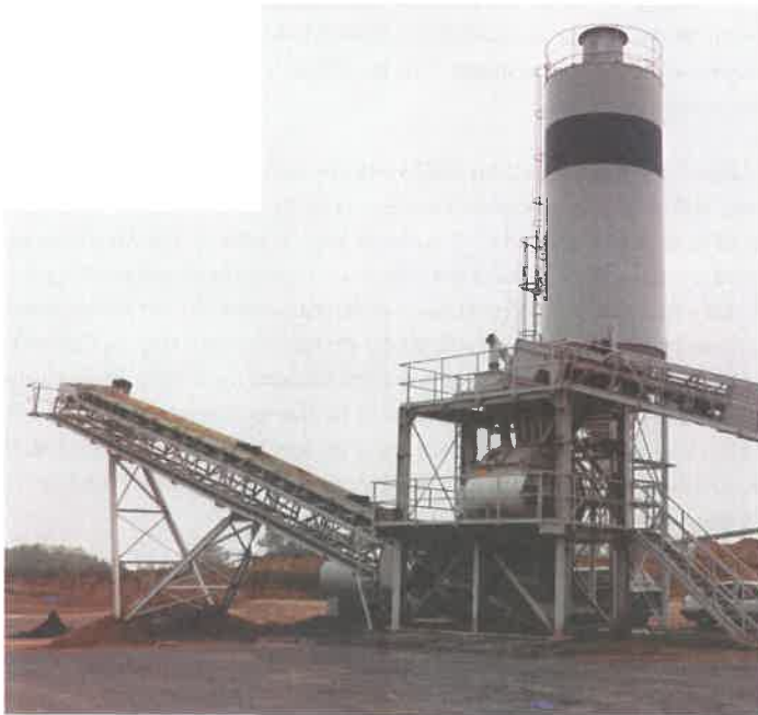
Abb. 4.3: Stationäre Mischanlage der Firma ROBERT BOPP, Talheim
