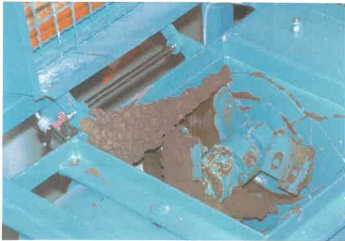
Abb. 4.2: Labormischstation der Firma BHS, Sonthofen
