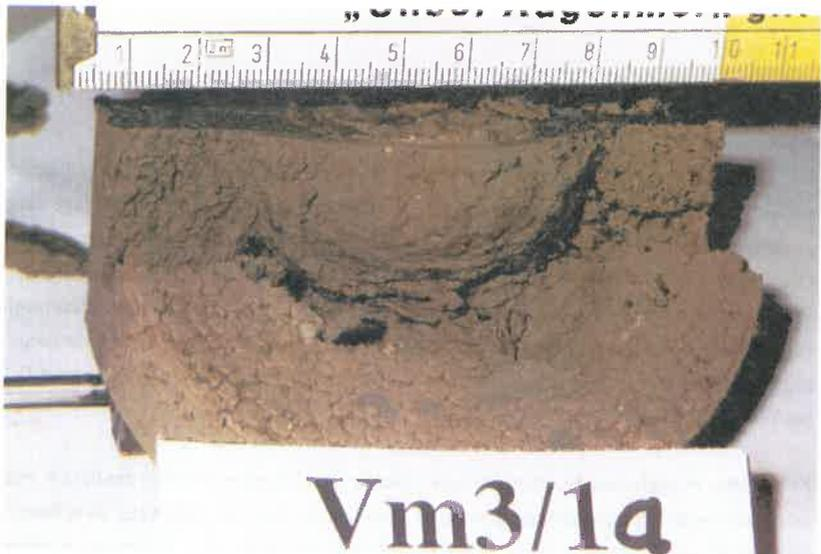
**Bild 5.8:** Kernform des Bruchkörpers
