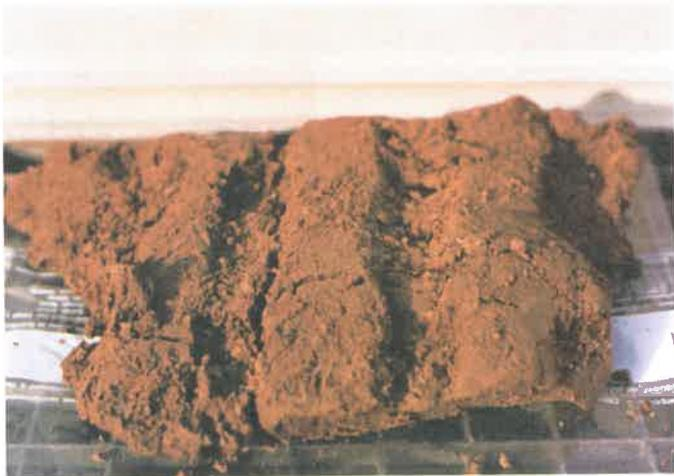
**Bild F 8:** herausgelöster Materialbrocken mit noch deutlich erkennbaren Noppenabdrücken des Verdichtungsgerätes
