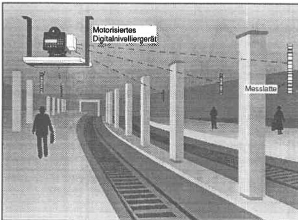
Bild 5: Montage der Geräte und Meßlatten
