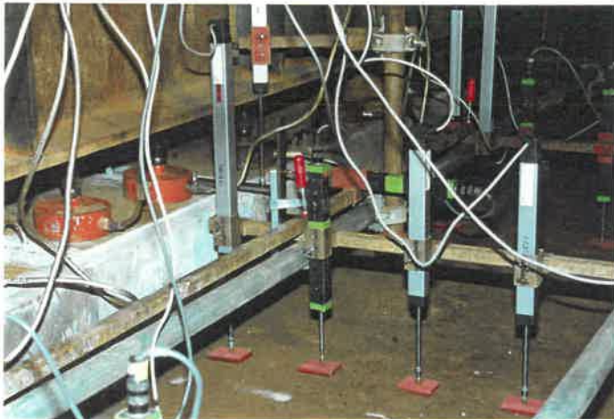
Bild A 82: Anordnung der Weggeber und Kraftmeßdosen im Detail
