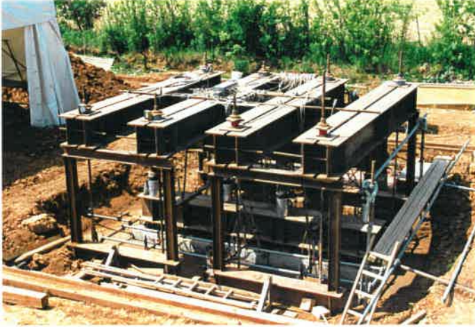
Bild A 79: Versuchseinrichtung Grundbruchversuche
