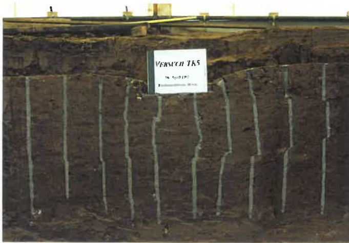
Bild A 85: Verformung der senkrechten Schlitzsondierungen
