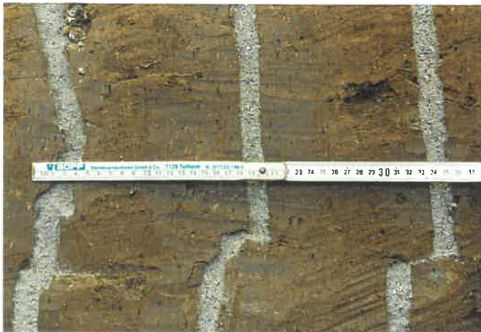
Bild A 86: Abgeschnittene Schlitzsondierungen im Detail
