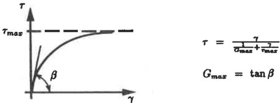
Bild 3 e: Belastungszeit des elastoplastischen Stoffgesetzes nach HARDIN-DRNEVICH
