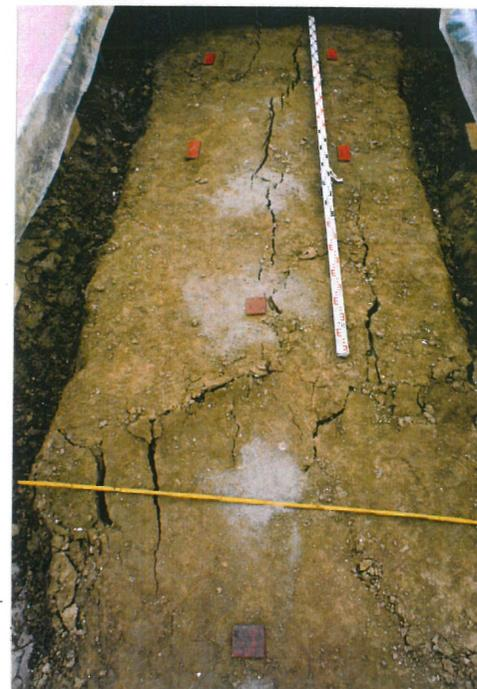
**Bild 9.12** Bruchkörper, Längs- und Querrisse, Parallelverschiebung, Draufsicht
