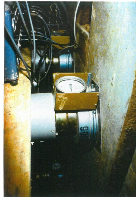
**Bild 9.7** Kraftmeßdosen für den horizontalen Erddruck: HBM-KMD (links) und Glötzl-KMD (rechts)
