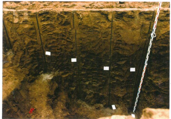
**Bild 9.10** Ausgegrabener Bruchkörper mit freigelegten Sand-
