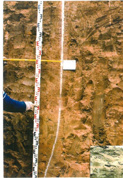
**Bild 9.13** Freigelegter Sand-schlitz im Abstand von 1,0 m von der Lastplatte
