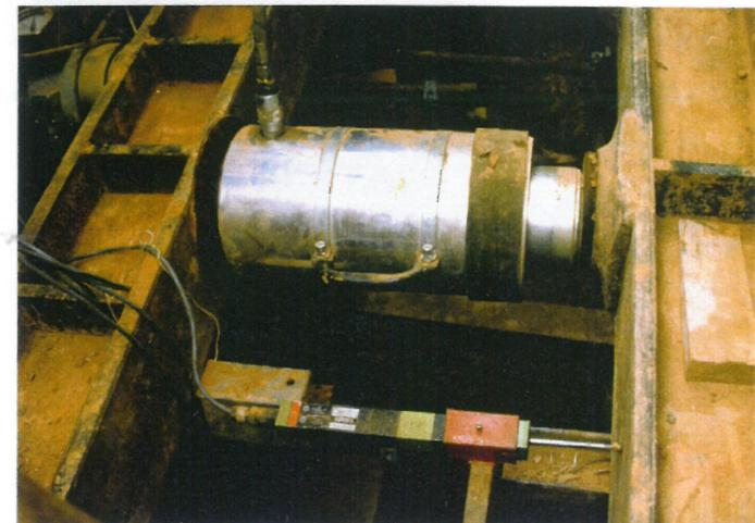
**Bild 9.8** Hydraulische Presse mit Lagern
