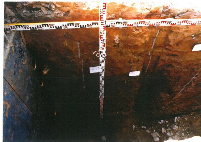
**Bild 9.11** Ausgegrabener Bruchkörper mit freigelegten Sandschlitzten, Drehung um Fußpunkt, Boden N, V 5
