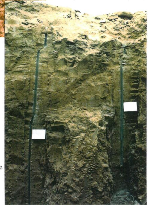
**Bild 9.14** Freigelegte Sandschlitzte im Abstand von 4,0 bzw. 5,0 m von der Lastplatte
