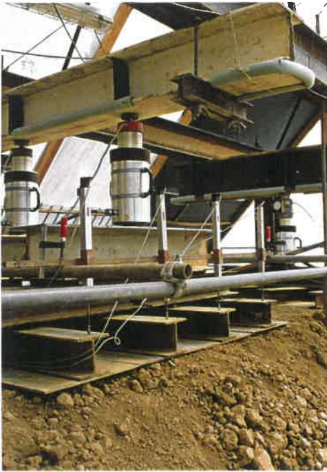
Bild 122: Widerlagersystem der Belastung
