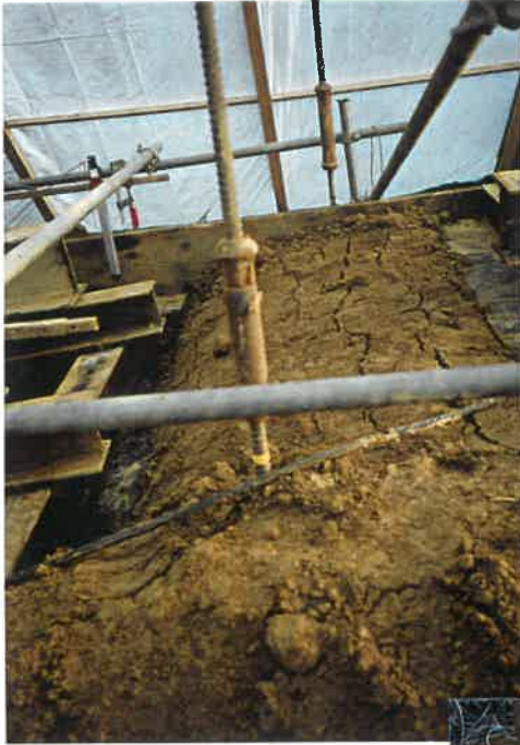
Bild 125: Ribbildung am Grubenrand (unbewehrter Versuch)
