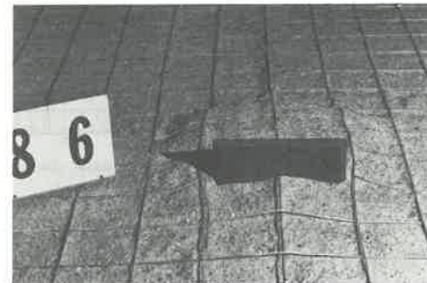
Abb.3.1-8 Bleidrähte auf z = +5 cm Platte 2o/2o von hinten Blick in y-Richtung dichte Lagerung, λ = 3
