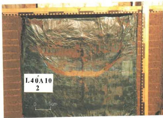
Bild 4.16 Beispiel der Bruchfigur im Schnitt II-2 nach Bild 4.6 beim Schlitzversuch
