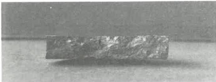
Bild 2.6: Opalinustonprobe als Ganzes und in der Mitte "aufgeschnitten"
