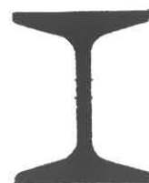
Bild H5.05 Typische Profile für Ausbaubögen
