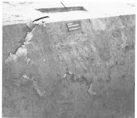
Bild 4.9: Verdichtung und seitliche Verdrängung des Bodens unter der Lastplatte
