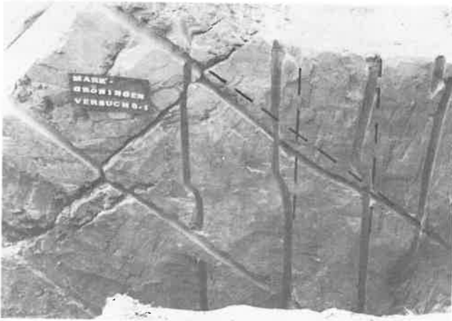
Bild 4.9: Verdichtung und seitliche Verdrängung des Bodens unter der Lastplatte
