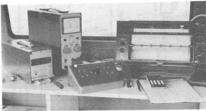
Bild 13 Meßwerterfassung mit Digitalvoltmeter,
