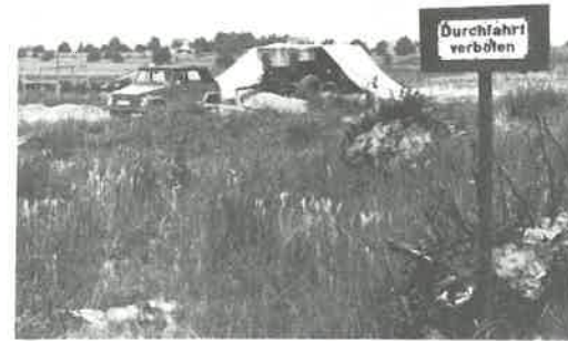
Belastungswagen mit Witterungsschutz für Versuchsstelle
