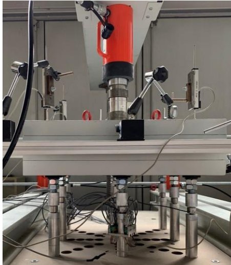
Abb.: Statische Probelastung einer 3 x 3 Verdrängungspfahlgruppe in der IGS Calibration Chamber
